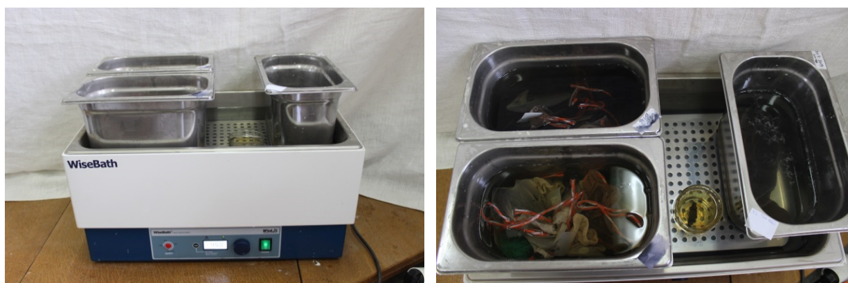
Elektrická ohřevná vana se dřevěnými artefakty ze záchranného archeologického výzkumu Česká 6 (A094/ 2012)
