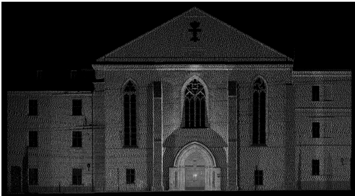
Orto pohled na západní průčelí kostela Povýšení sv. Kříže v Jihlavě. Výstup ze 3D skenování.
