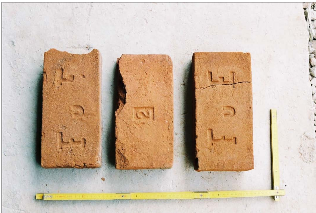
Obr. 6 Cihly z konstrukce pece
